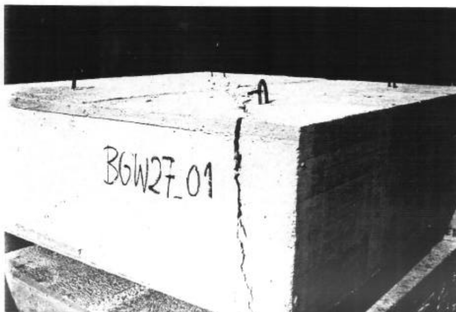
Abbildung 9. Versagensart Spalten.
