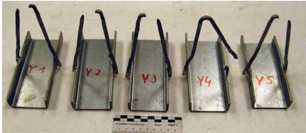
Bild 01 Ankerschienen BGWTU-A aus feuerverzinktem Stahl
