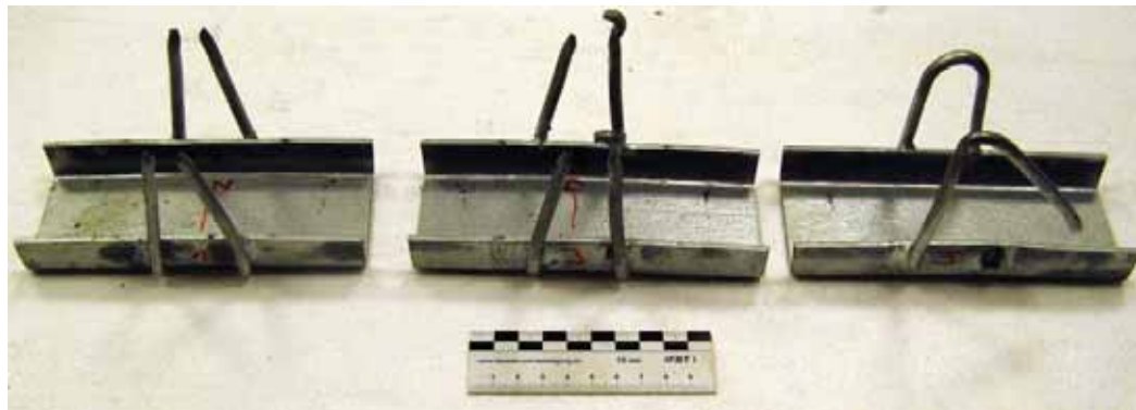
Bild 02 Ankerschienen BGWTU-D aus feuerverzinktem Stahl
