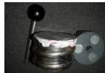
*Per impedire che la pasta di cemento penetri nell'apertura e danneggi la parte di installazione e il sistema magnetico, la parte di installazione è sigillata con nastro adesivo.*
