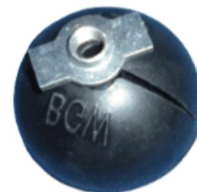
Il corpo incassato BGW (ASK) stretto è realizzato in gomma e viene utilizzato per fissare gli ancoraggi a sfera in componenti stretti, sulla cassaforma o all'interno di essa. Nel corpo incassato viene installato il dado di fissaggio o la vite di fissaggio. Il KKA viene inserito nella bocca aperta dell'incasso. Durante il fissaggio alla cassaforma, la bocca del corpo incassato viene chiusa avvitando o serrando la vite per garantire che il KKA sia saldamente in posizione.
