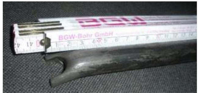
Lunghezza del traversino tubolare per una portata della staffa di ancoraggio di 3,7 t = spessore del muro in calcestruzzo - 74 mm, per 4,5 t - 75 mm, per 5,8 t - 78 mm, per 8,5 t - 82 mm
