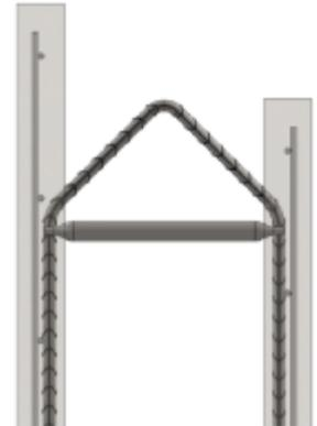
L'ancoraggio di trasporto BGW Fili14 con acciaio di rinforzo Ø 12 è progettato per un carico assiale di 3,7 tonnellate, Ø 14 per 4,5 tonnellate, Ø 16 per 5,8 tonnellate e Ø 20 per 8,5 tonnellate.
