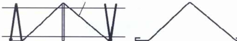
Bild 5: Rückhängebewehrungsstab Ø10 für höhere Querkzugtragfähigkeiten.
