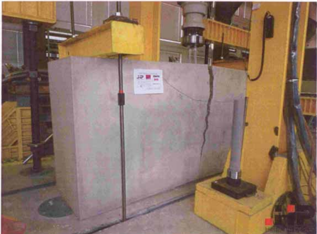
Bild 85 Versuchskörper im Versuchsstand mit weit aufgehendem Spaltriss infolge unzureichender Biegebewehrung
