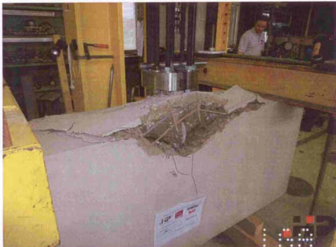
Bild 44 Versuchsende bei fortgeschrittenem Betonausbruch
