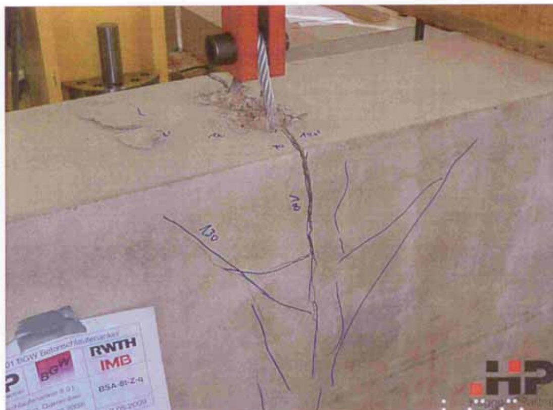
Bild 38 Versuchsende bei deutlicher Rissbildung und Spalten des Versuchskörpers infolge unzureichender Biegebewehrung
