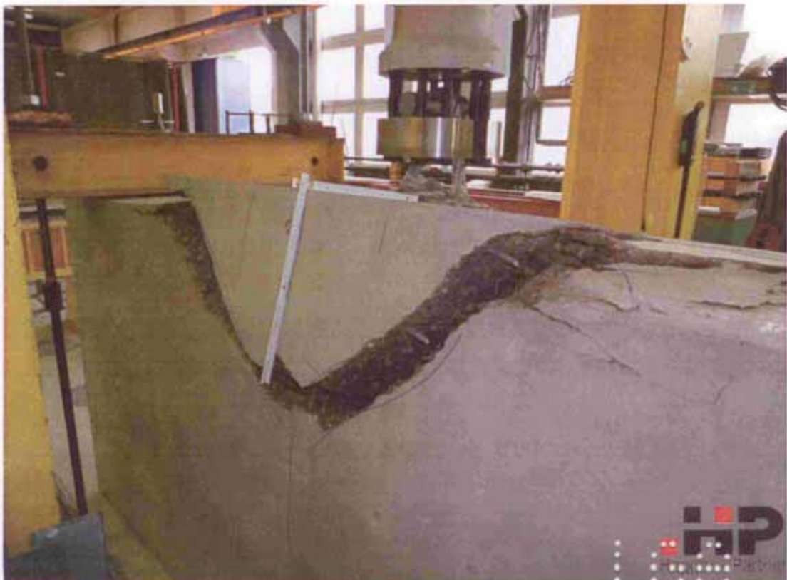
Bild 76 Kegelförmiger Betonausbruch mit gebrochenen Bewehrungsstäben
