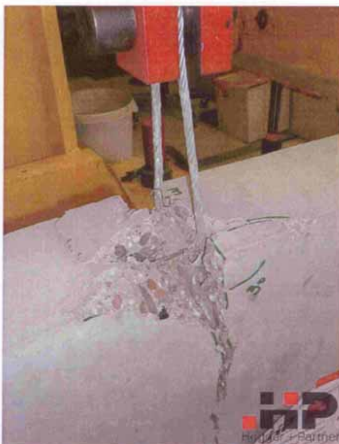
Bild 12 Oberseitiger Betonausbruch, Spalten des Versuchskörpers infolge unzureichender Biegebewehrung
