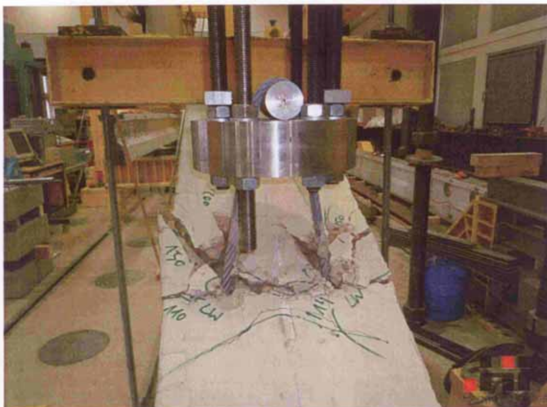
Bild 57 Versuchsende: Oberseitige Betonabplatzungen
