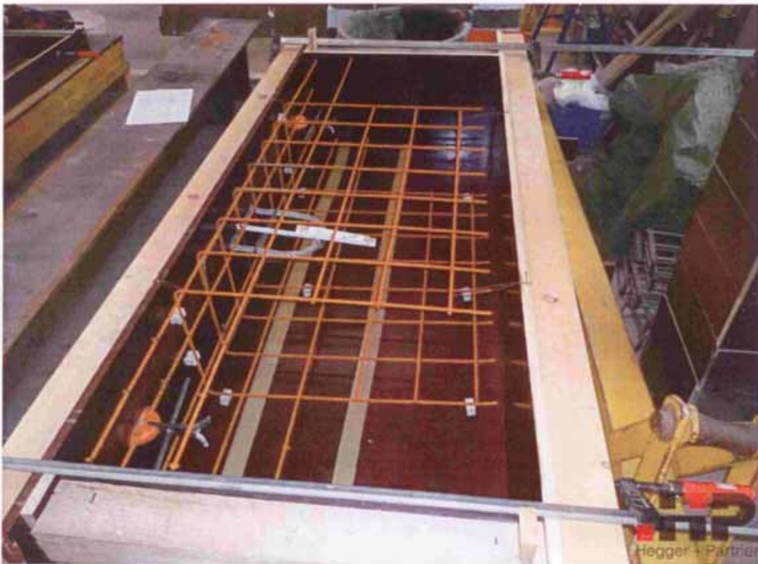
Bild 29 Versuchskörper mit Anker bei der Herstellung
