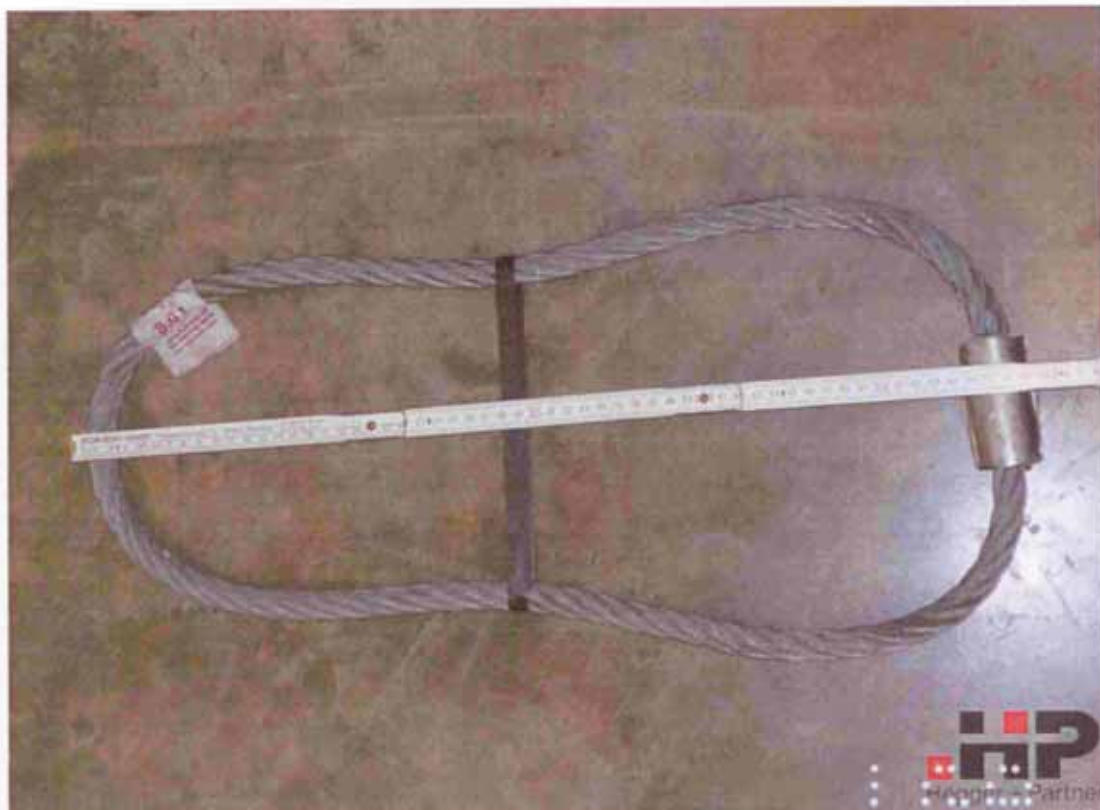
Bild 46 Anker für Schrägzugversuche mit Extramaßen: 58cm lang, 27,5cm breit
