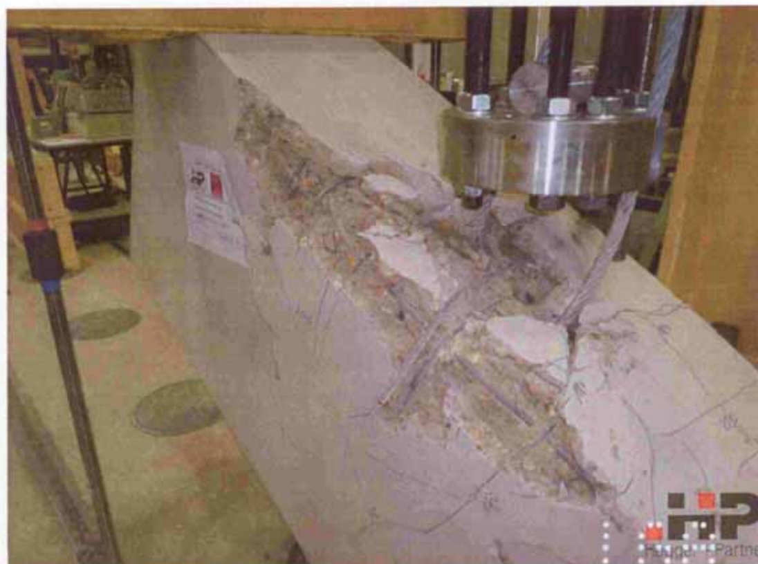
Bild 50 Versuchsende mit Betonausbruch und beginnendem Herausziehen des Ankers
