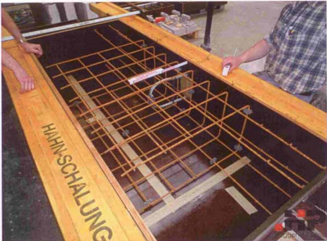
Bild 35 Versuchskörper mit Bewehrungskorb und Anker bei der Herstellung
