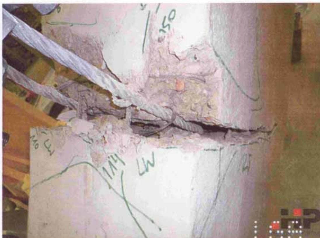
Bild 58 Versuchsende: klaffender Biegeriss, komplett durchgetrennte Horizontalbewehrung
