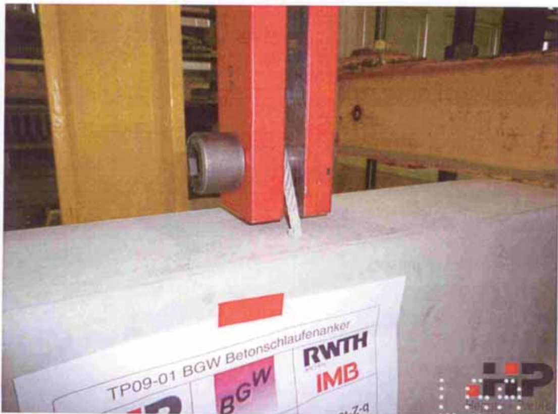
Bild 10 Versuchskörper im Versuchsstand mit Lastaufnahmedetail
