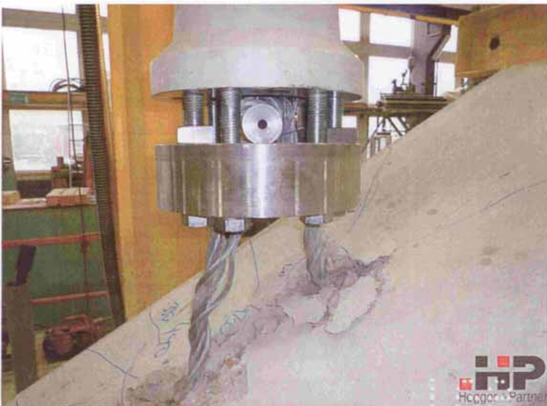
Bild 64 Versuchsende: Bruch des Ankerseils (zu geringer Hebebolezendurchmesser)
