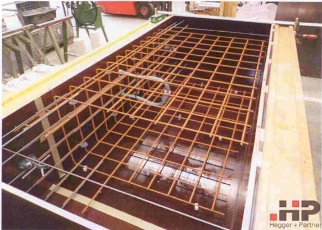
Bild 83 Versuchskörper mit Bewehrungskorb und Anker bei der Herstellung
