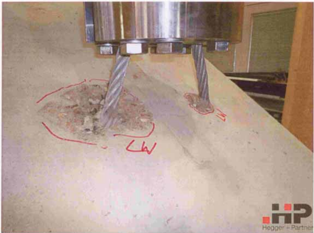
Bild 69 Lokale Betonabplatzungen im Zuge der Lastwechsel
