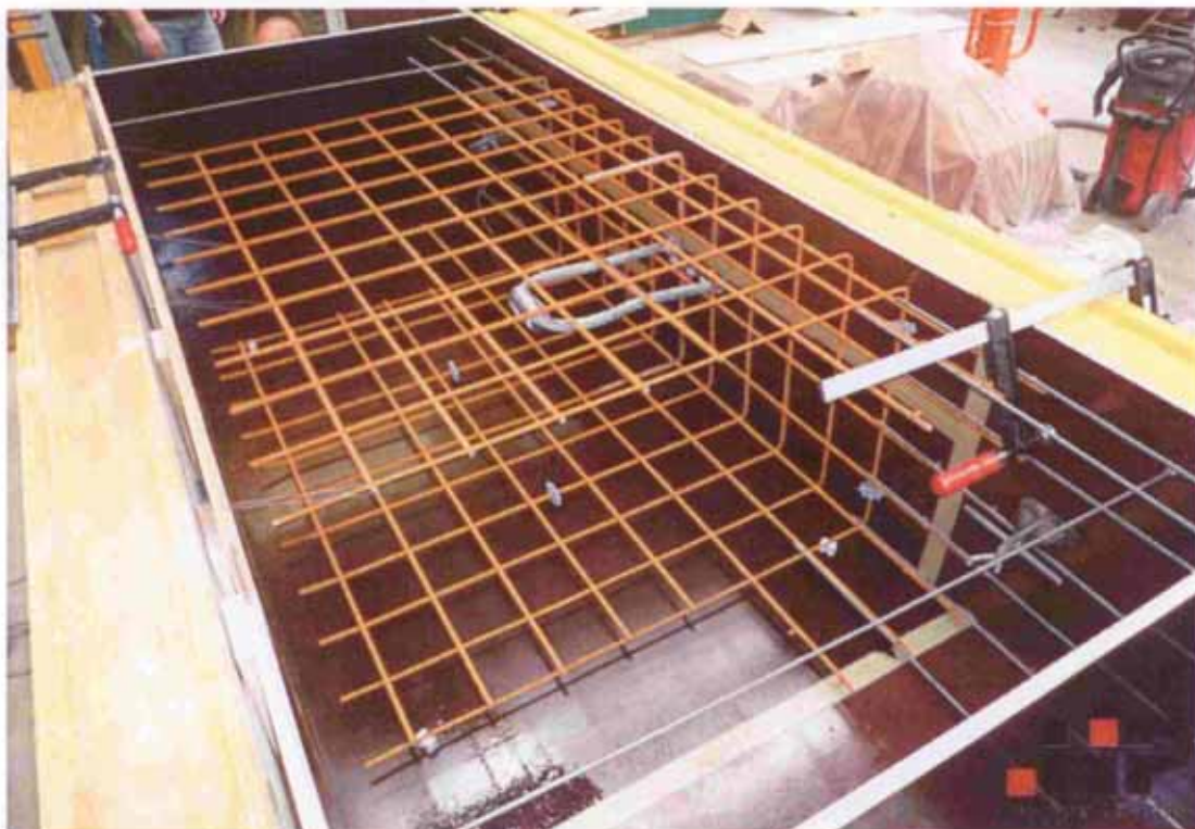
Bild 73 Versuchskörper mit Bewehrungskorb und Anker bei der Herstellung
