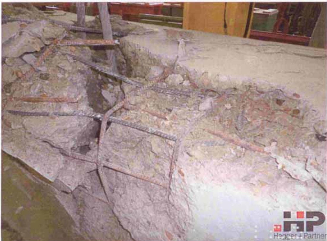
Bild 82 Versuchsende mit gebrochenen Bewehrungsstäben und zugezogener Ankerschleife
