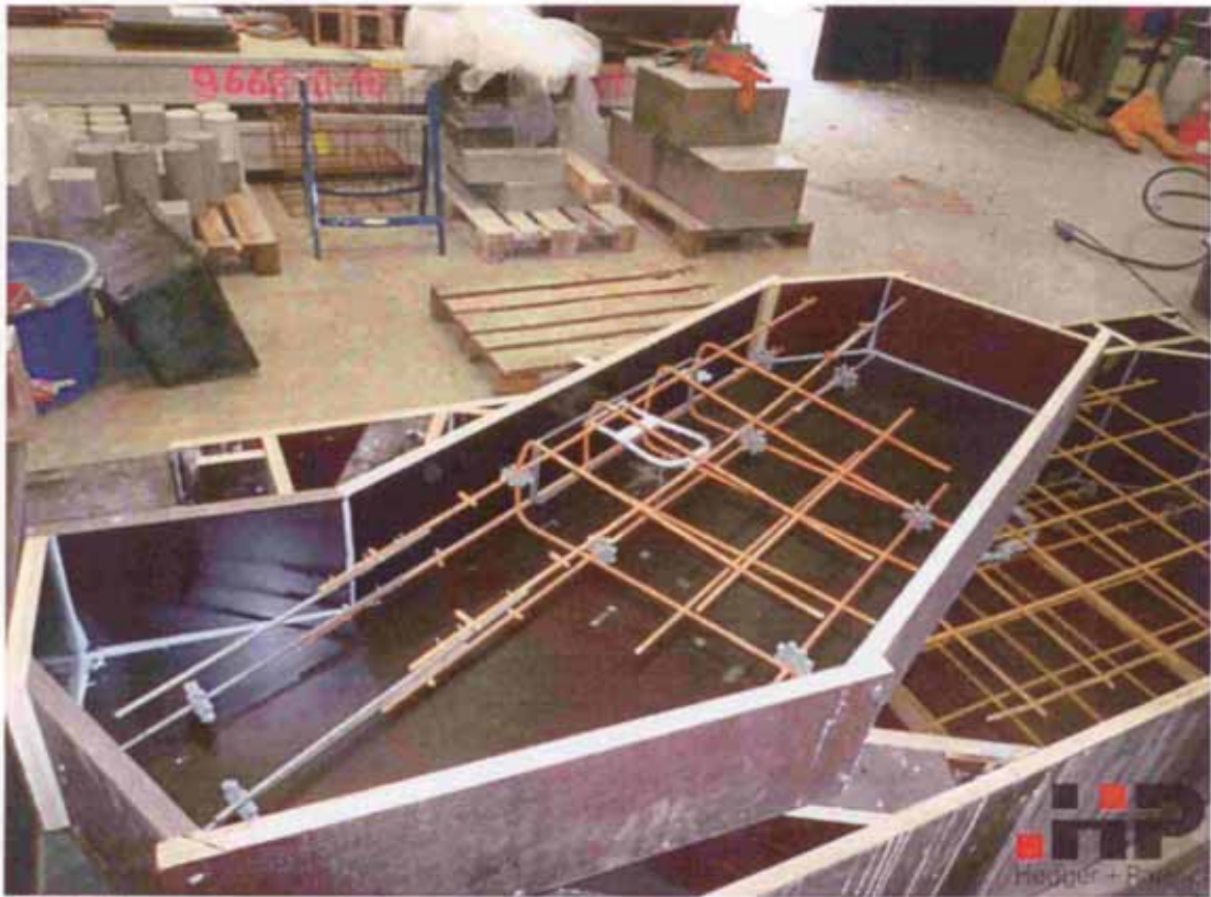
Bild 13 Versuchskörper mit Anker, Bewehrungskorb und Zulagebewehrung
