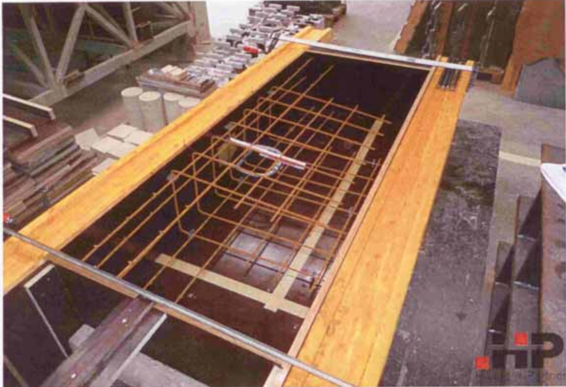
Bild 25 Versuchskörper mit Bewehrungskorb und Anker bei der Herstellung
