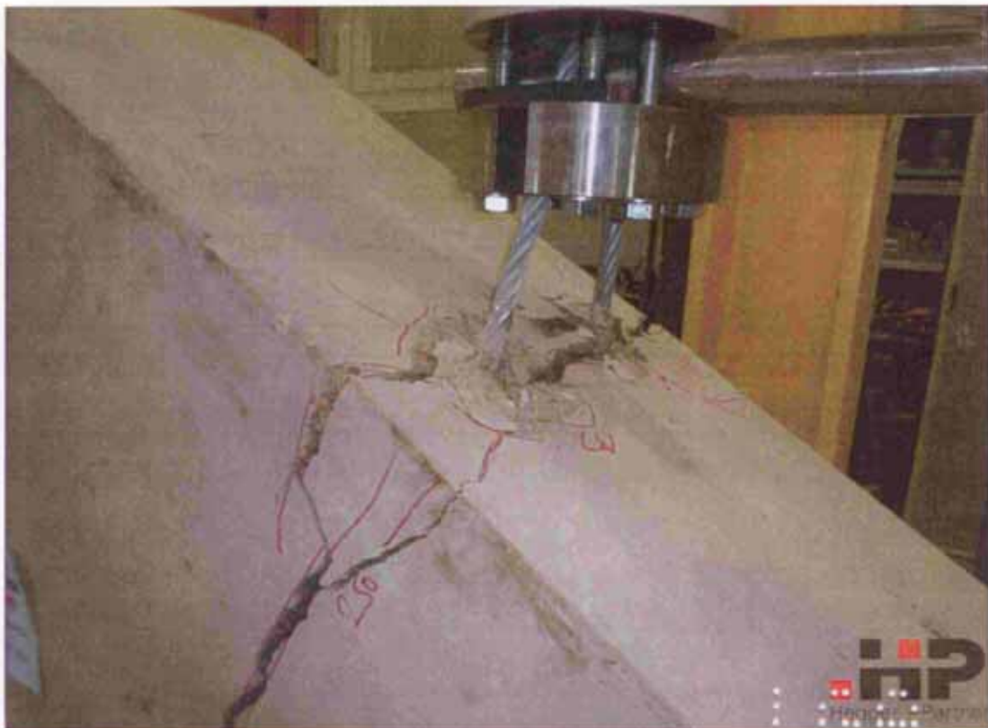
Bild 72 Versuchsende bei stark klaffendem Biegeriss – kein Betonausbruch
