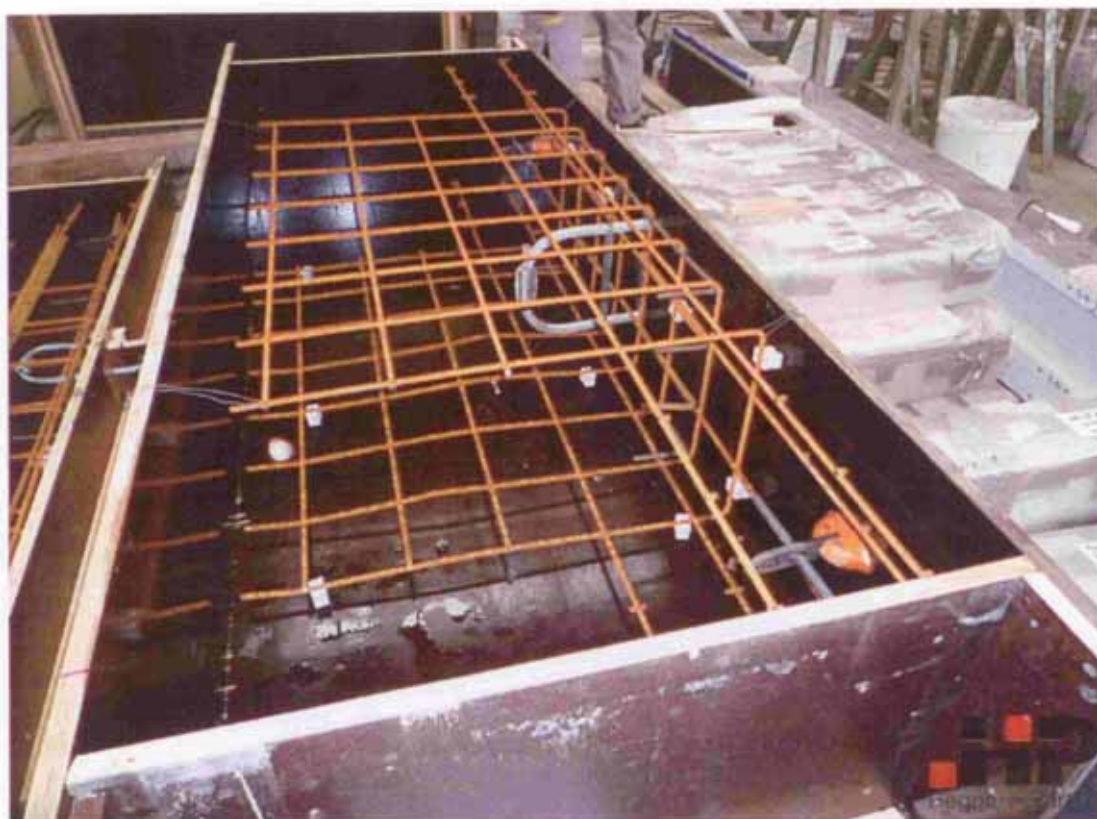
Bild 39 Versuchskörper mit Anker bei der Herstellung
