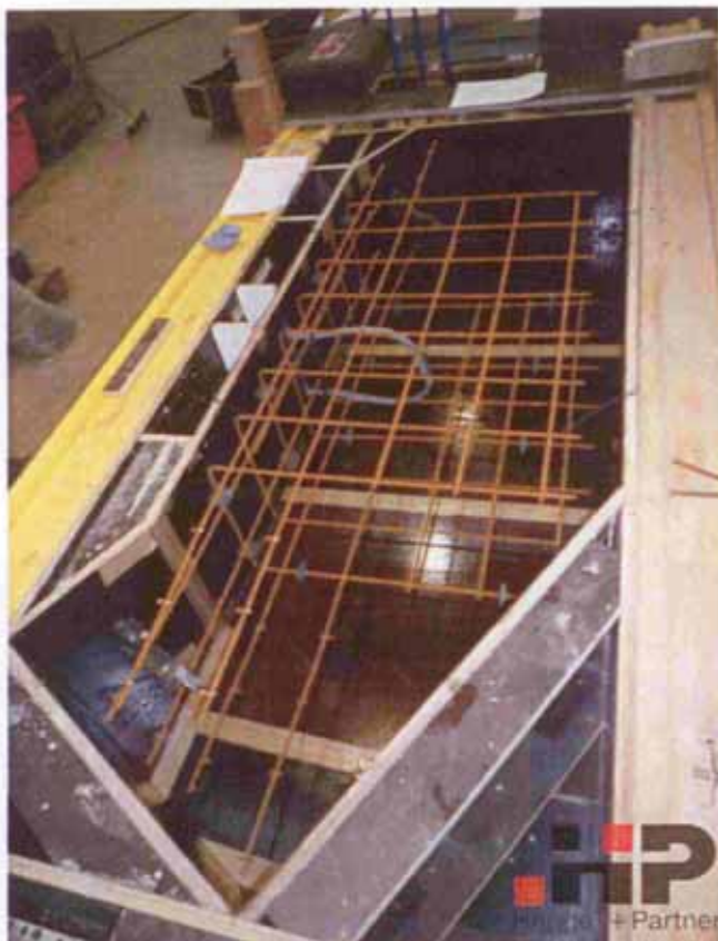
Bild 51 Versuchskörper mit Anker bei der Herstellung
