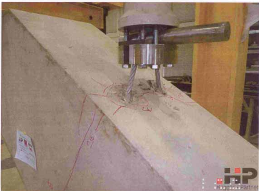
Bild 70 Tieflaufender Biegeriss bei Höchstlast (359 kN)
