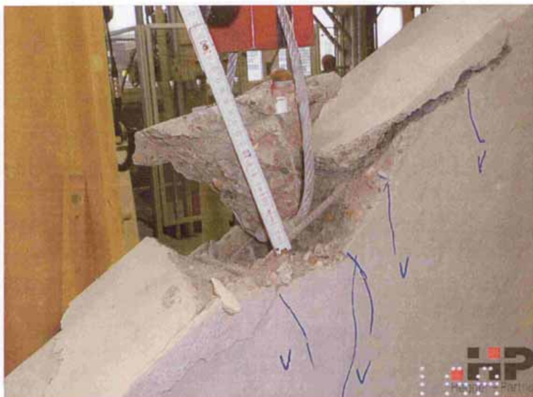
Bild 24 Betonkegelausbruch und Herausziehen des Ankers
