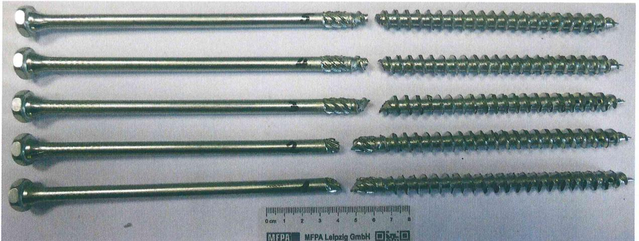
2-3: Bruchlage von Ankerschrauben nach dem Zugversuch
