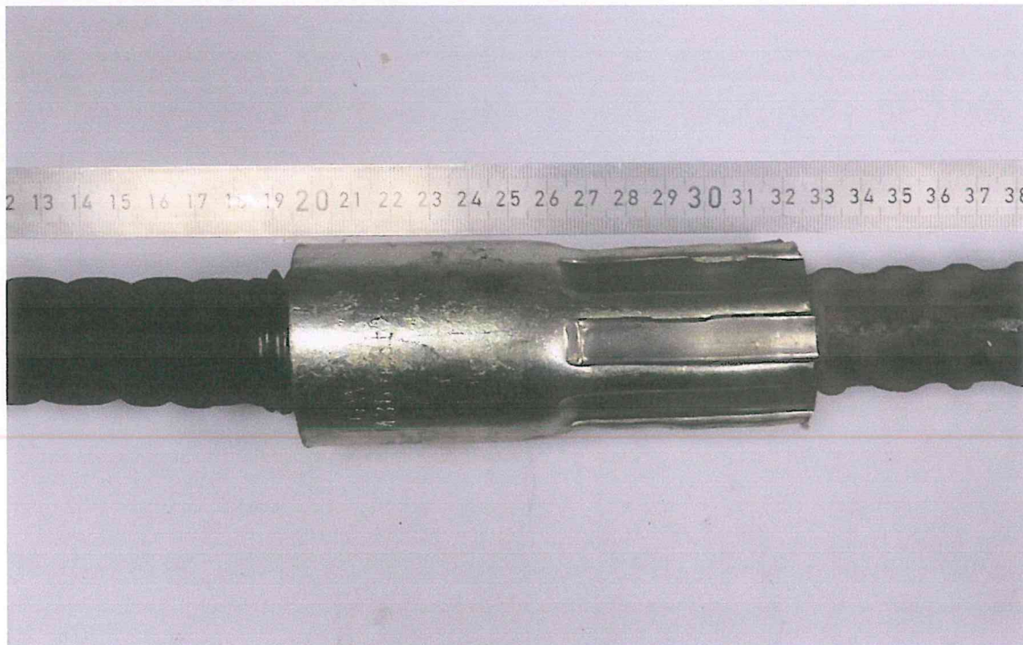
b: Einzelaufnahme einer Muffenverbindung mit Maßband Abbildung 1.1: Anlieferungszustand des Probenmaterials
