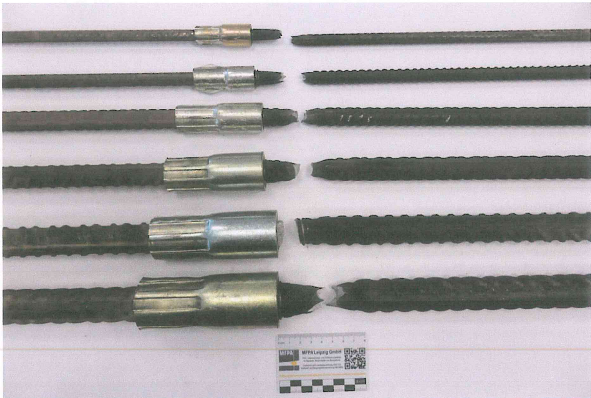
Abbildung 3.1: Bruchlage der Muffenverbindungen nach dem Zugversuch
